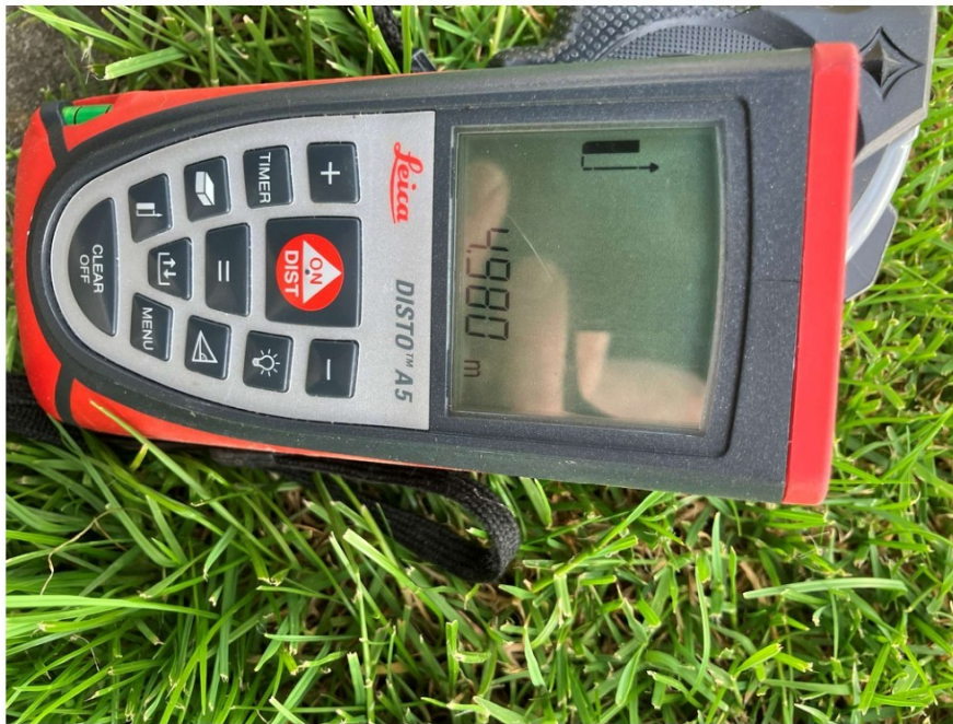
1) Deelmeting voorgevel bijgebouw op positie 1 ; onderzijde vorst(dakpan) tot verharding
